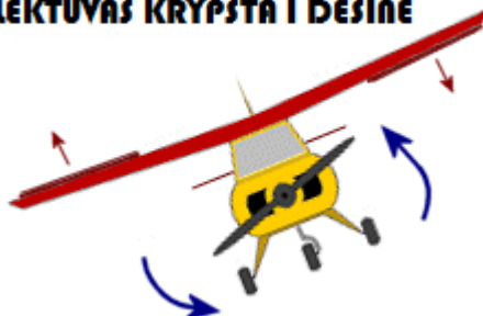
KAIRYSIS AILERONAS I APACIA, DESINYS I VIRSU - LEKTUVAS KRYPSTA I DESINE
